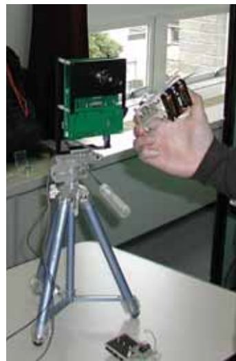
三脚に設置された CMOS カメラと手で持っているビーコン[松下氏(ソニー CSL)他, ID Cam: 画像上のビーコンを読み取る ID 認識カメラ]。
