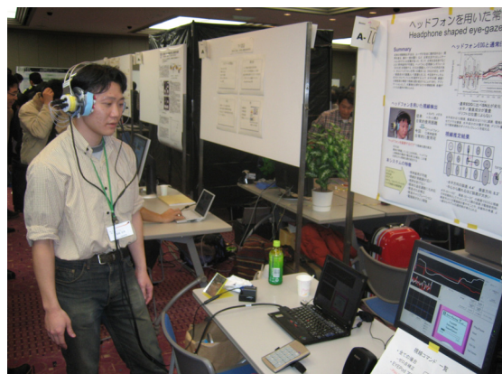
図9 ヘッドフォンを用いた常時着用視線インタフェース
